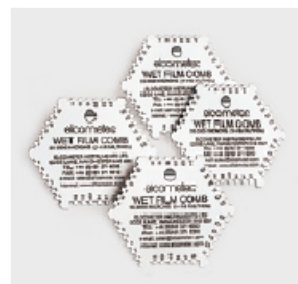
Гребенка для измерения толщины мокрой пленки
